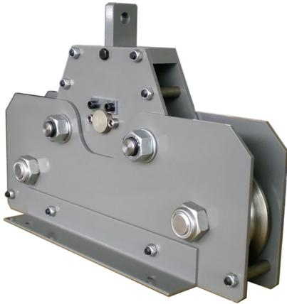
RL형 장력검출기는 달리는 케이블의 온라인 장력검출을 위해 특별히 설계되었으며, 장력검출기는 직경 15~115mm의 케이블에 사용할 수 있으며 최대 장력은 500톤까지 측정할 수 있다. 케이블의 응력 구조를 변경하지 않고 동적 및 정적 케이블 장력을 감지하는 문제를 해결할 수 있습니다.
