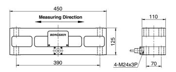
수평하중 감지형 텐션메터 입니다. 고강도 합금강을 일체형으로 기계가공하여 높은 과부하 특성 및 정밀도를 가지고 있습니다. 가혹한 환경에 적합하도록 설계 되었으며 제철소 강판 생산라인등의 장력측정용으로 적합합니다.
