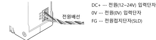
※ RS-485 커넥터의 SLD(실드), RS-232C 커넥터의 Shell(실드)는 전원 커넥터의 FG와 내부에서 접속하고 있습니다.
